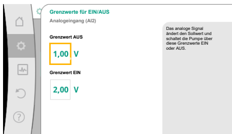
Fig. 80: Grenzwerte zur EIN/AUS-Steuerung über Analogsignale
