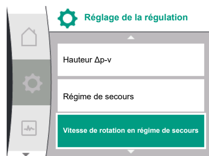
Fig. 73: Menu Réglages de la régulation avec mode régime de secours en cas de défaut de la valeur de capteur
