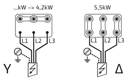
$\sim 3~400V~50Hz$  /  $\sim 3~380{-}460V~60Hz$
