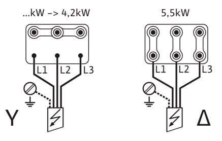
$\sim 3~400V$  50Hz /  $\sim 3~380{-}460V$  60Hz
