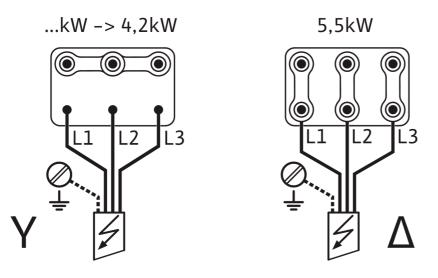
$\sim 3~400V$  50Hz /  $\sim 3~380{-}460V$  60Hz
