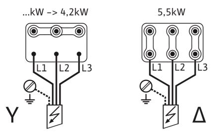
$\sim 3~400V$  50Hz /  $\sim 3~380{-}460V$  60Hz
